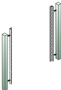
Fixer les profil en aluminium sur les poteaux. Déterminer si vous les monter du côté "route" ou "jardin".
