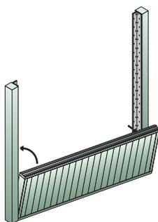
Monter le 1<sup>er</sup> panneau en commençant par celui de départ (rainures en dessous, languettes au dessus). Le bois est du côté "jardin", et la mousse absorbante du côté "route".
