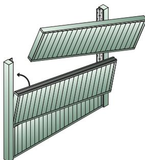
Mettre au milieu un autre panneau de départ (à rainures et languettes), puis terminer par un panneau de fin (rainures en dessous, lisse ou dessus).
