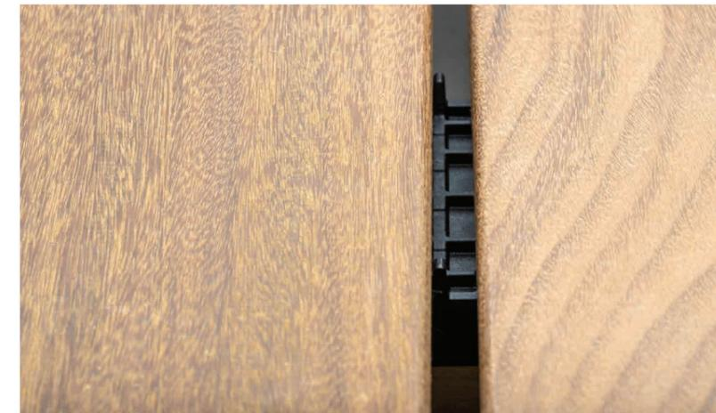
Protection de la lambourde grâce au capotage formé par le dispositif d'emboîtement des deux fixations adjacentes qui recouvre intégralement la lambourde au niveau des espacements entre lames.
