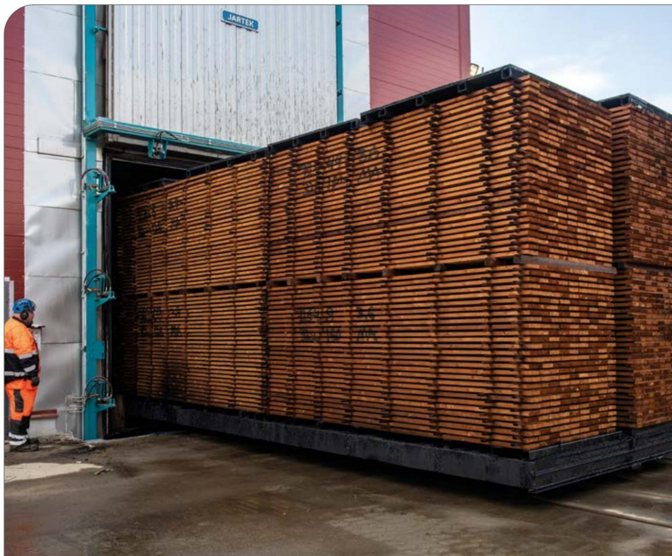
Figuur 4. ThermoWood® wordt vervaardigd in een verwerkingsdroger.
