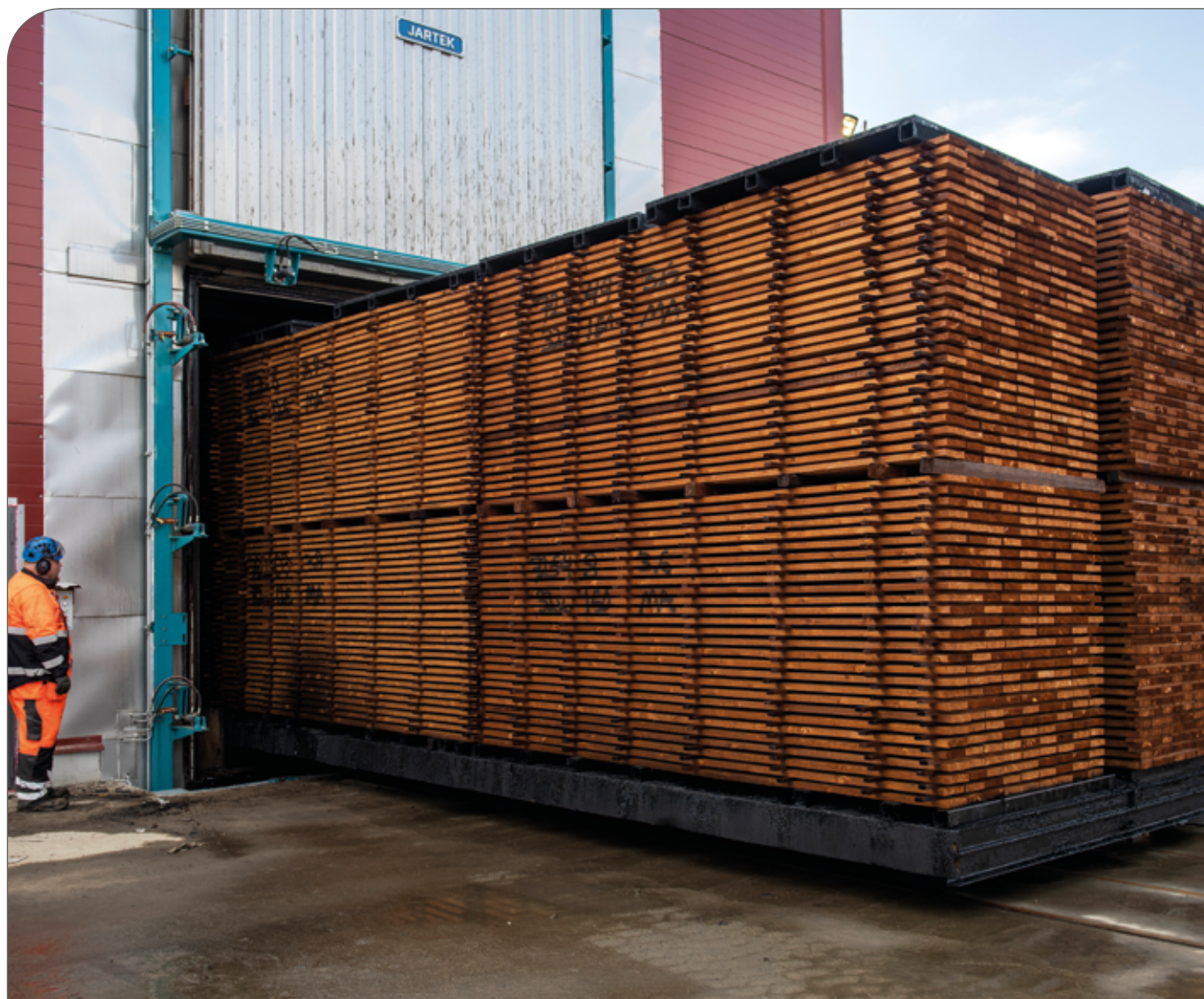
Figure 4. ThermoWood® en cours de fabrication dans un séchoir de traitement.
