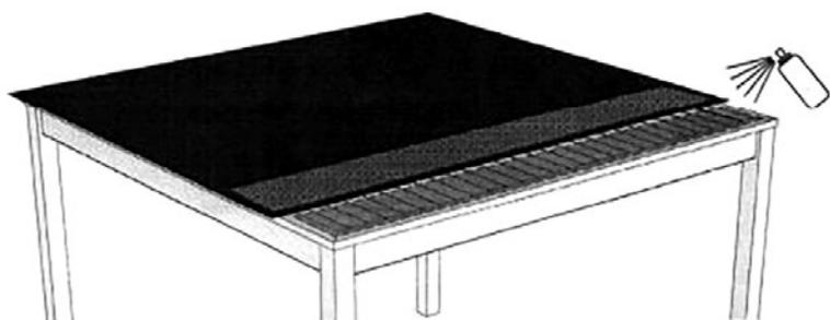
**2** D'un côté, décollez un peu le revêtement en caoutchouc. Vaporisez de la colle sur le bois et la feuille de caoutchouc. Il peut être nécessaire de pulvériser une couche supplémentaire de colle sur le bois. Attendez environ 2 minutes et appliquez progressivement la feuille de caoutchouc sur le bois (éventuellement à l'aide d'un pinceau).
