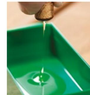
Afin d'éviter le débordement en surface de la colle PU dû à son expansion durant le séchage, il est conseillé de limiter la quantité de colle utilisée en ne l'appliquant que sur l'extrémité du bouchon.
