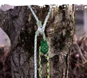
Longe fausse fourche réglable avec le prussik. La corde passe sur une poulie Pinto Rig permettant une fluidité exceptionnelle de la corde en travail. La large épissure renforcée permet un décrochage facile sans rester coincé dans les branches grâce à sa souplesse. CE EN 795B
