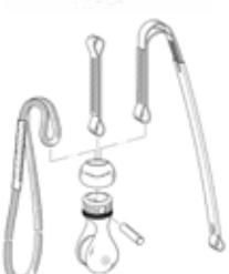
Katrol door de ronde vorm uiterst geschikt om in te bouwen in een cambiumsaver, kan rechtstreeks verbonden worden met een strop of bandlus (zonder karabijnhaak), ideaal om een «in-line-ankerpunkt» te creëren op een dubbele klimlijn. Rode signaallring is zichtbaar als de katrol niet voldoende is dichtgeschroefd. Conform EN12278 - diam. lijn <= 14mm - breuksterkte = 22kN - hoogte = 85mm - gewicht = 138g
