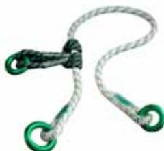
Een frictionsaver met twee ringen. Deze verminderen de wrijving en slijtage van de klimlijn en vergt dus minder inspanning bij het klimmen. De langere frictionsavers worden geleverd met een Sirius ringloop. Deze kan met een prussikknoop op de lijn worden gezet om een verstelbare frictionsaver te maken. De ringen zijn van 26mm & 34mm diameter. CE EN 795B
