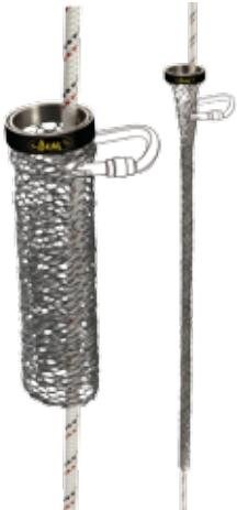
Gepatenteerde metalen vlecht gebruikt om het touw of leeflijn te beschermen tegen scherpe randen of gereedschappen. Deze soepele touwbescherming is veel duurzamer en effectiever dan een conventionele touwbescherming. De ROPE ARMOUR moet over het touw en geplaatst worden via de uiteinden. Zo beschermt het tegen haakse slijpers, schuur- of boormachinies. Om op te bergen kan het worden samengedrukt, volledig uitgetrokken voor een precieze plaatsing op het touw.
